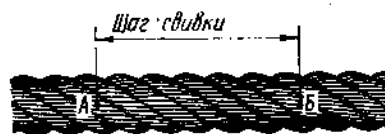
Малюнок 2.3 - Приклад визначення кроку свивки шестипрядного каната
